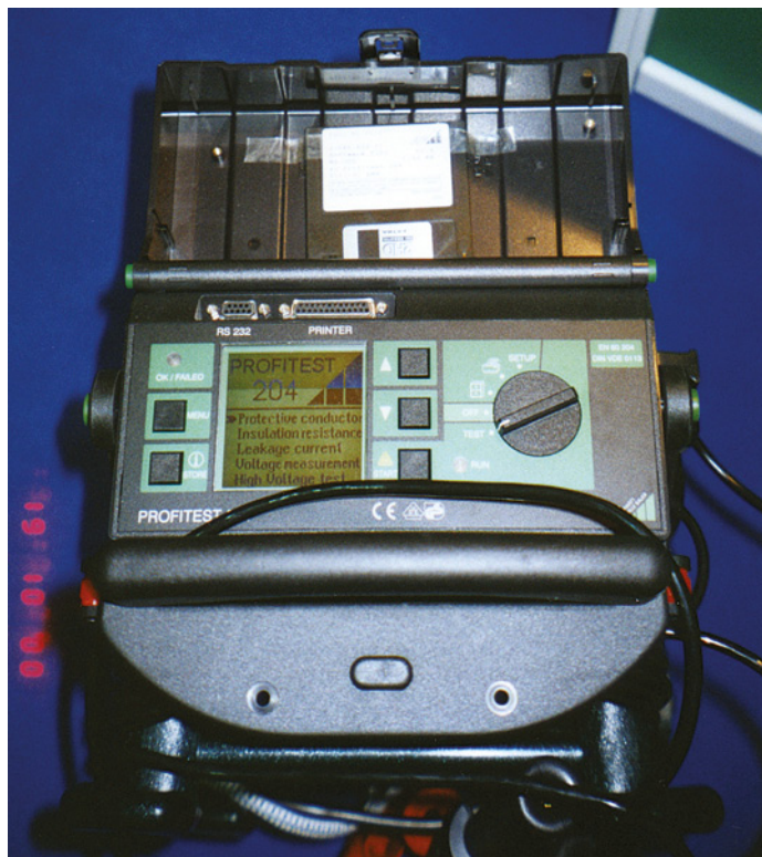
Joonis 21.6. Masinate elektriseadmete testimisel kasutatavad mõõteseadmed erinevad ehitiste elektripaigaldiste mõõtmiseks kasutatavatest mõõteriistadest
