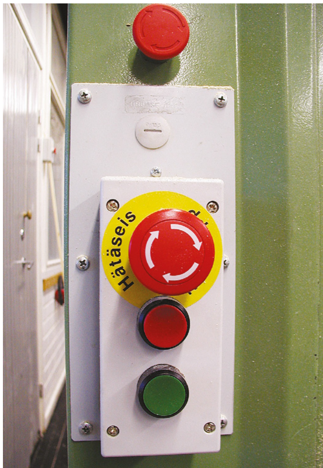
Joonis 21.5. Vajaduse korral peavad masinal olema hädaseiskamisseadmed
