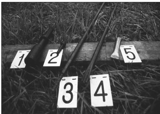
Рисунок 44. Металлическая трубка в качестве электрода и элементы проводной системы
