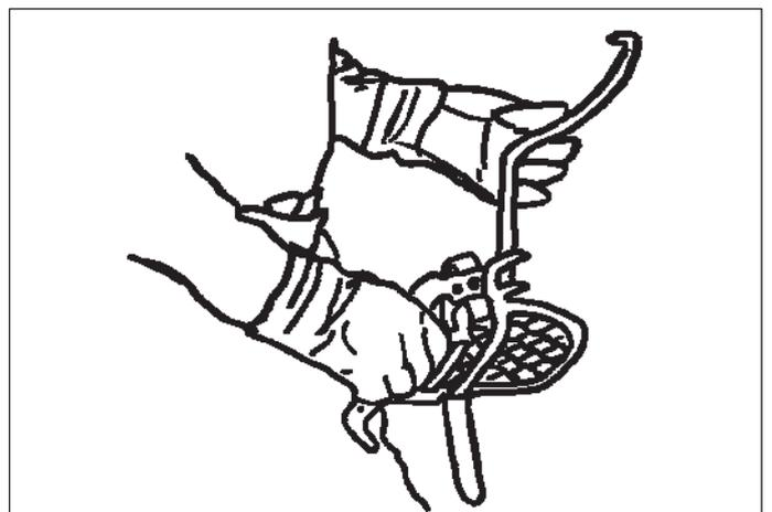
Рисунок 146. Исправность монтерских когтей и предохранительного пояса проверяется ежедневно.
