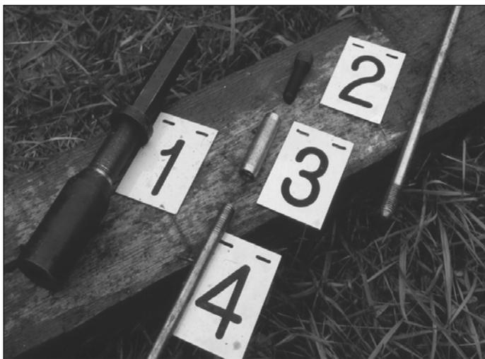
Рисунок 42. Элементы системы металлического стержня, используемого в качестве электрода
