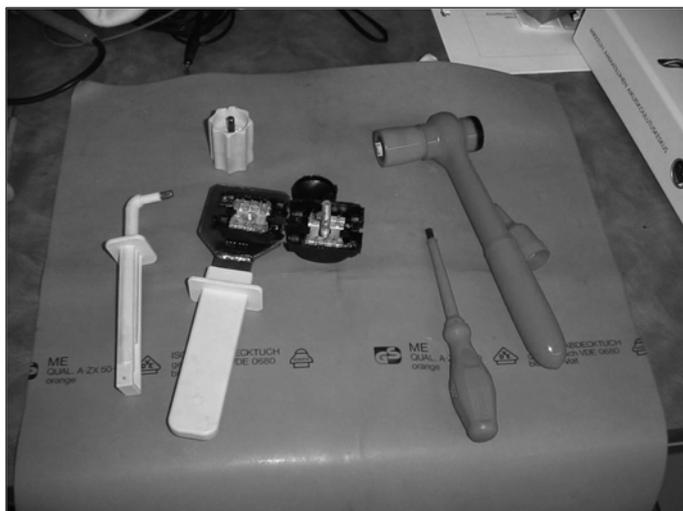
Рисунок 294. Рабочие инструменты для работы под напряжением на проводах АМКА (JT-MILLENNIUM).
