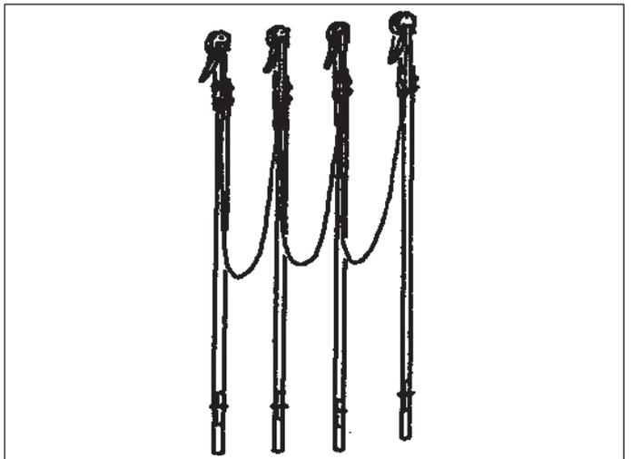
Рисунок 505. Заземляющее устройство со штангами для воздушной линии электропередачи 0,4 кВ с неизолированными проводами.
