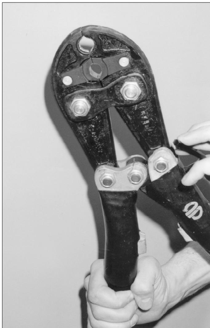
Рисунок 260. Регулировка силы прессования обжимных клещей (MD6).
