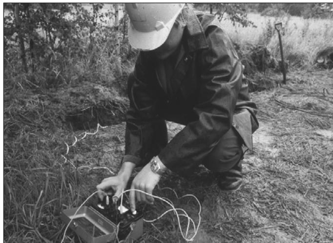
Рисунок 48. Измерение сопротивления заземления на местности.
