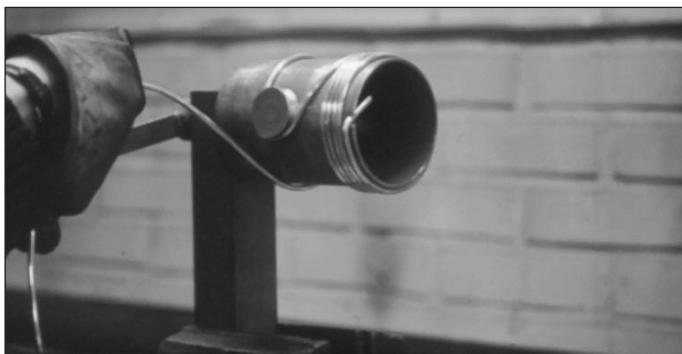
Рисунок 356. Производство проволочной катушки.
