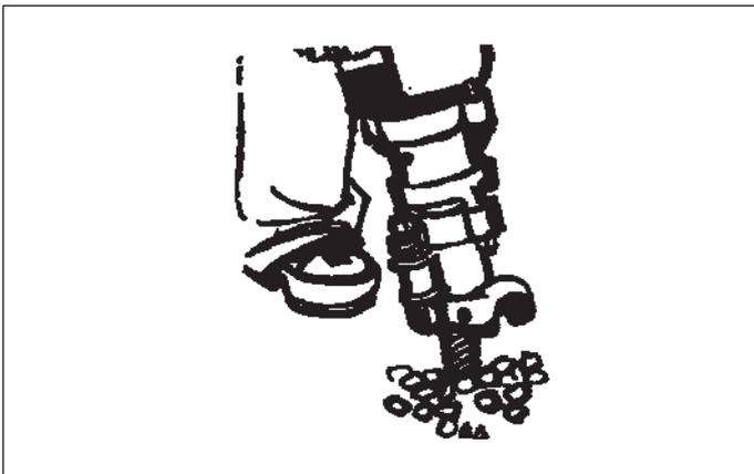
Рисунок 196. Машина запускается без бура.
