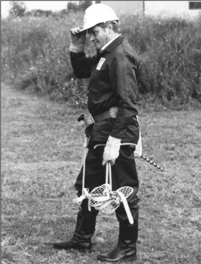
*Рисунок 156. При переходе на следующую опору монтажные когти снимаются с обуви, поскольку перемещение на монтажных когтях является опасным, и вызывает растягивание ремней монтажных когтей.*
