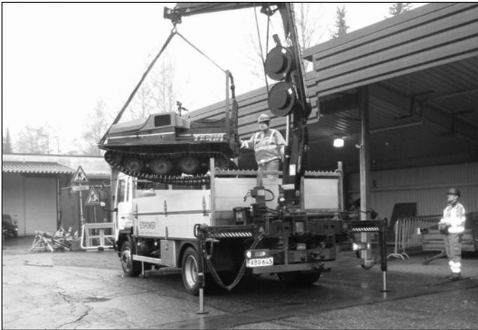
Рисунок 125. Грузоподъемник в режиме подъема (Empower).
