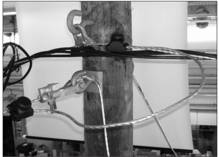
Рисунок 263. Образец соединения провода PEN при ответвлении проводов АМКА.
