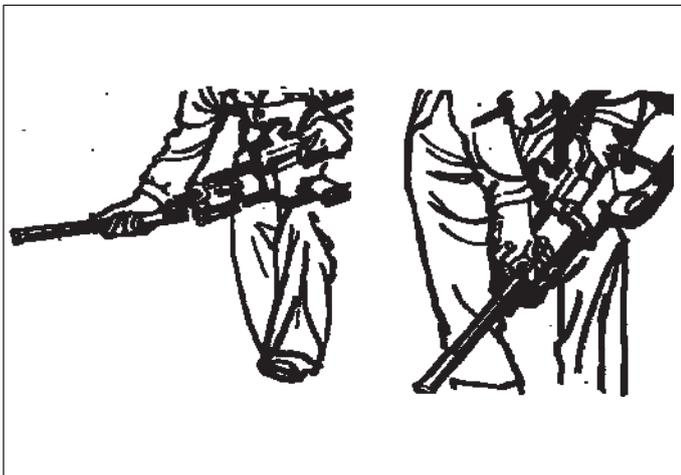
Рисунок 197. Установка бура в машину.
