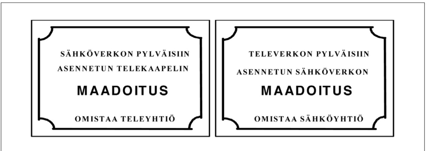
Рисунок 448. Маркировка совместного заземления опор (YJ1:08 7.3).
