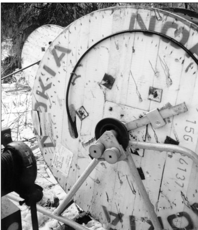
Рисунок 334. Барабан с проводом, установленный на подставку с тормозом.
