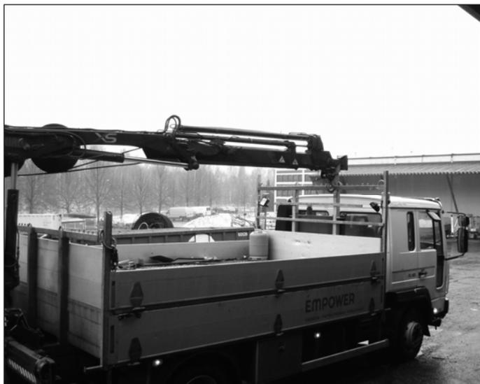
Рисунок 118. Грузовой автомобиль, оснащенный транспортными стойками для перевозки опор (Empower).
