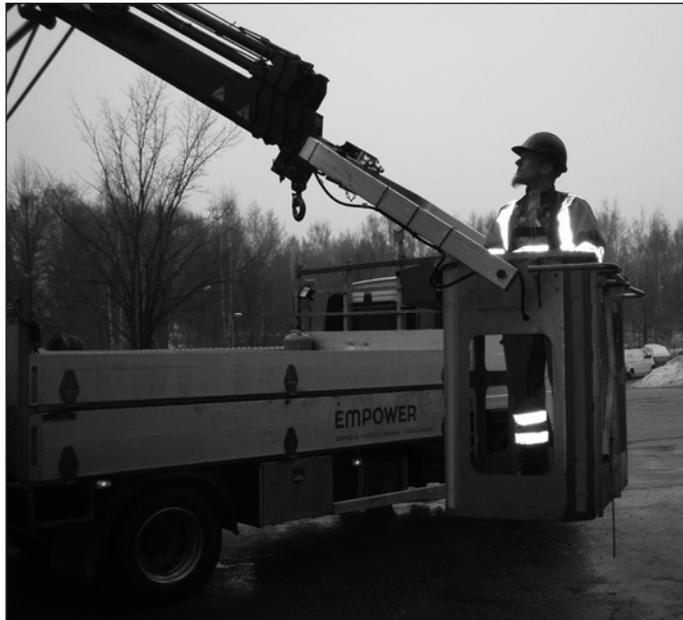
Рисунок 126. Клетка для подъема людей, применяемая в сетевых работах (Empower).
