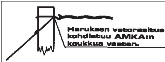
Рисунок 222. Установка оттяжки за поддерживающий крюк.
