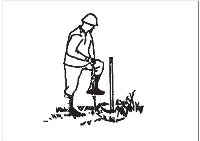
Рисунок 472. Начало выемки котлована под опору.
