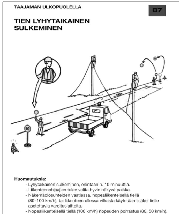
Рисунок 137. Краткосрочное перекрытие дороги за пределами населенного пункта. (Организация дорожного движения при производстве сетевых работ, пример В7)
