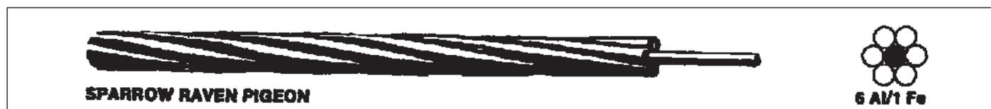
Рисунок 299. Конструкция сталеалюминиевого провода.
