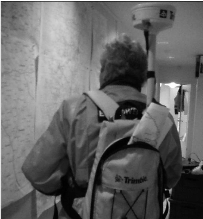
Фотография 81. Устройство GPS, пригодное для работ по проектированию на местности.
