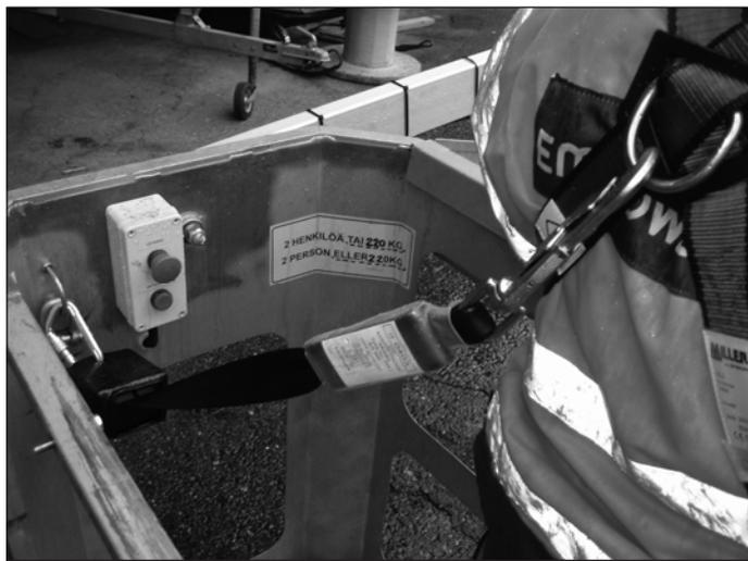
Рисунок 127. Предохранительные устройства в клетке для подъема людей (Etrower).
