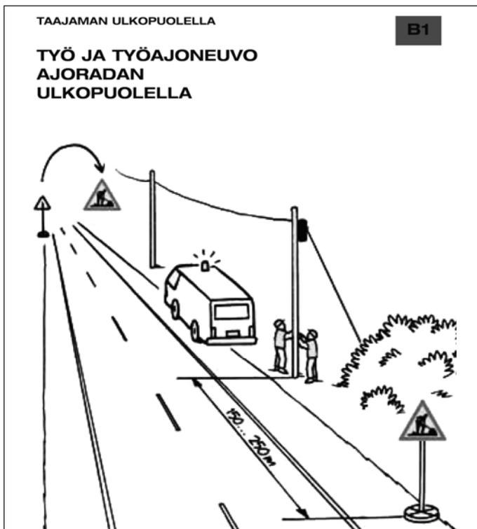
Рисунок 136. Работы и рабочее транспортное средство за пределами проезжей части. (Организация дорожного движения при производстве сетевых работ, пример В1)
