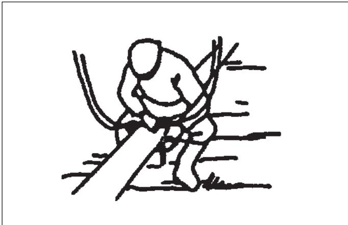
Рисунок 479. Крепление подъемного троса к опоре.
