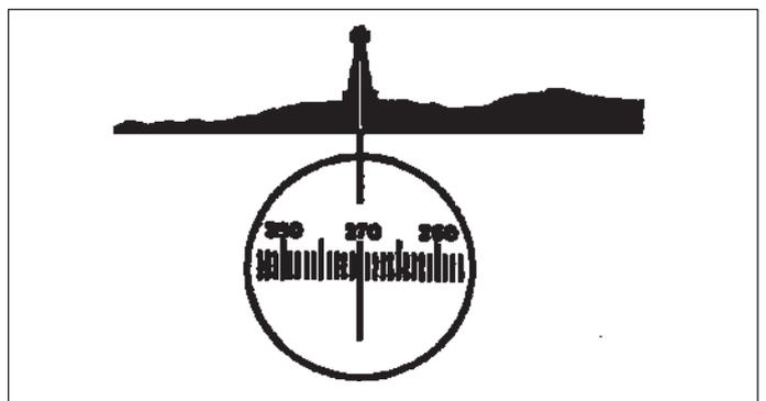
Рисунок 83. Визирование с помощью компаса-пеленгатора.
