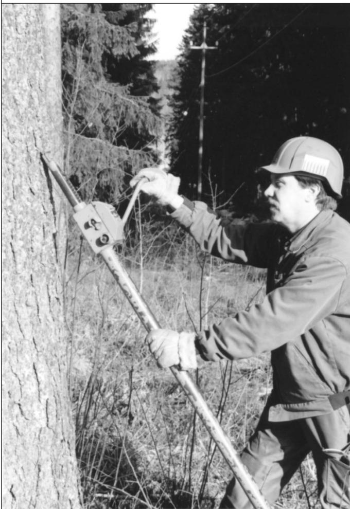
Рисунок 107. Обеспечение направления валки дерева.
