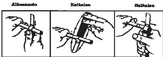
Рисунок 258. Удаление изоляции с фазного проводника.
