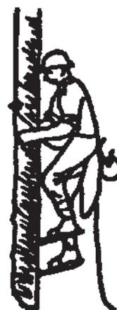
Рисунок 342. Одновременная установка тягового троса и монтажных роликов.
