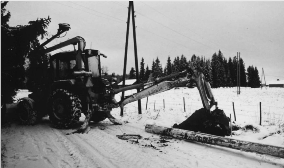
Рисунок 159. Экскаватор для установки опор.
