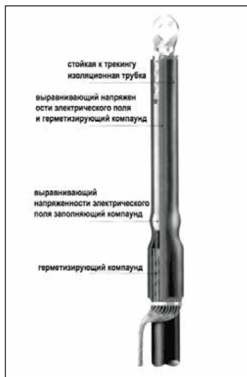
Joonis 127. Termokahaneva plastmuhvi ehitus.
