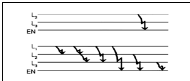
Joonis 22. Ühefaasiline ja mitmefaasiline lühis.
