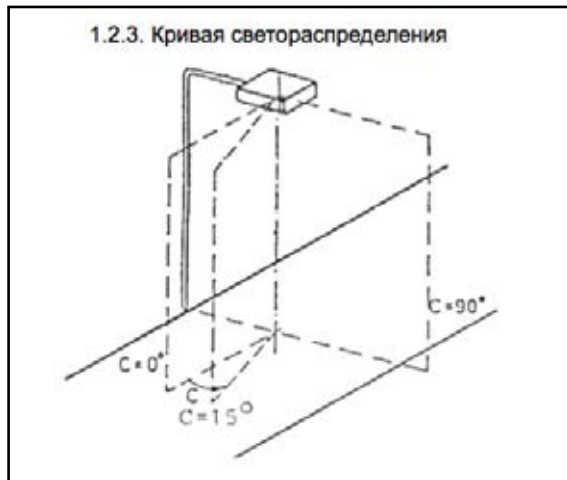
Joonis 10. Joonisel on näidatud suunad C, mille korral esitatakse tee- ja tänavavalgustite valguse jaotuskõver.
