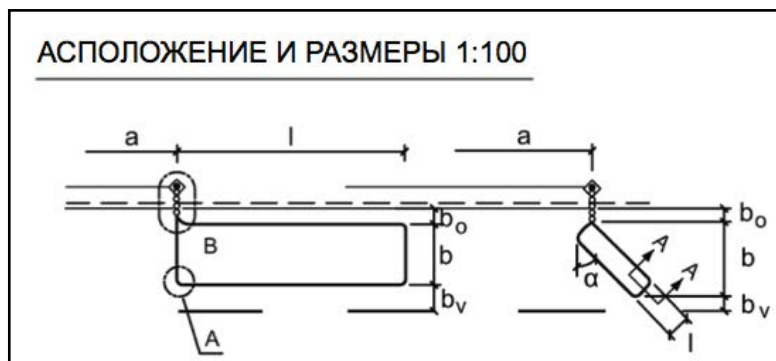
Joonis 18. Andurisilmuse paigaldamise põhimõttejoonis (Soome Maanteeamet Ty12/234).
