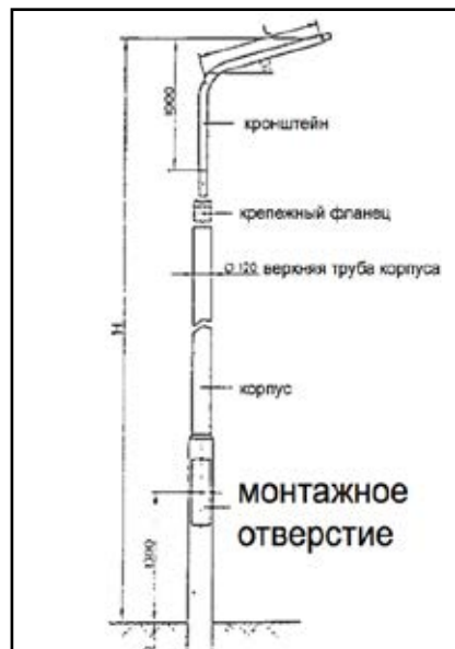
Joonis 70. Üksiku valgustimasti koostejoonis.
