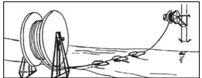
Joonis 212. Kaabli vettelaskmine ujukottide abil.
