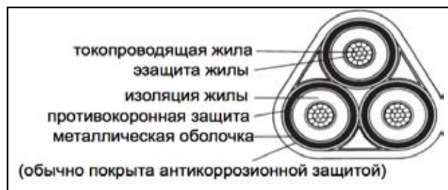
Joonis 4. Mitmemantlilised kaablid, nt AHXAMK-WM.
