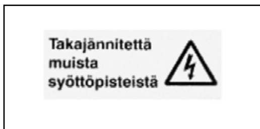
Joonis 202. Hoiatussilt ringvõrgus tagasituleva pinge eest (YJ 8:09 joonis 15.)
