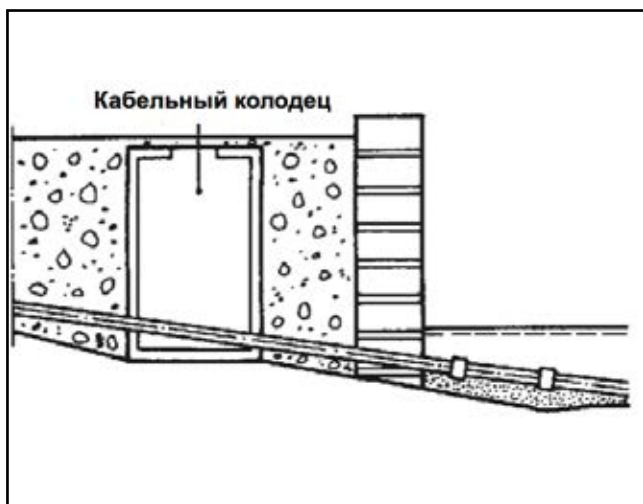
Joonis 86. Betoonist kaablikaev.
