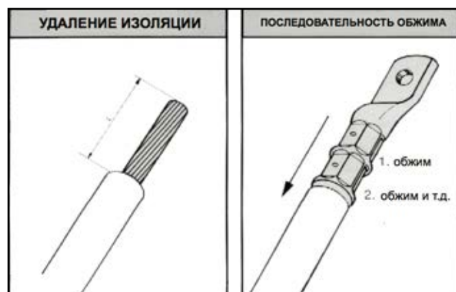
Joonis 151. Pressitava kaablikinga kinnipressimine.
