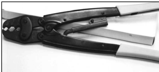
Joonis 150. Väikese ristlõikepinna korral kasutatavad pressimistangid.
